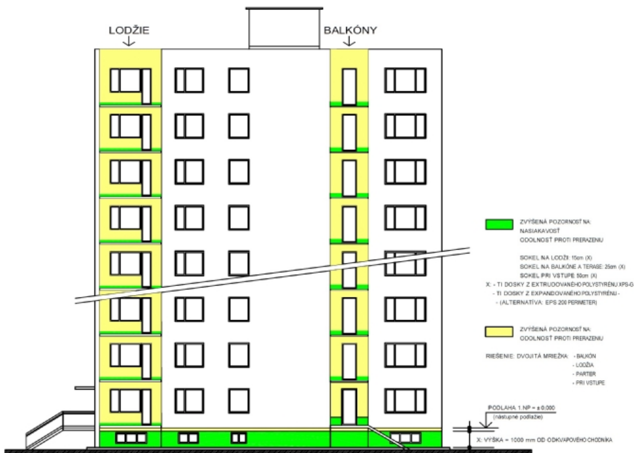
Obrázok 5: Schéma oblastí obvodového plášťa bytového domu so špecifickými požiadavkami z hľadiska užívateľských požiadaviek
